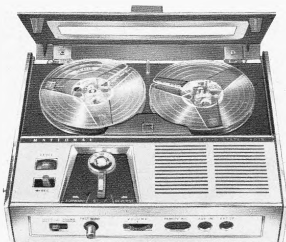
NATIONAL RQ-401S Zweispur; Geschwindigkeit 4,75 und 9,5 cm/sec.; Spulen \varnothing 11 cm; Ausgangs- leistung 700 m W; Maße: 25,1 x 8,5 x 22,1 cm; empfohlener Preis: DM 259,- ohne Zubehör plus Gema.
