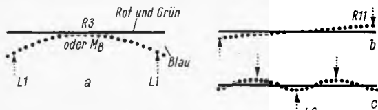
Bild 10. Mit L 1 wird der zeilenfrequente Parabelstrom und mit R 11 dessen Phasenlage (Sägezahn-Stromanteil) für die Konvergenz der blauen Linie mit den horizontalen roten und grünen eingestellt. Dabei wird die in a gezeigte und hauptsächlich vom System her bedingte starke Verzeichnung zu der in c gezeigten verkleinert. Die zu erkennende schwache Wellenlinie wird durch Einstellung eines mit L 6 auf zweifacher Zeilenfrequenz arbeitenden Schwingkreises ausgeglichen
